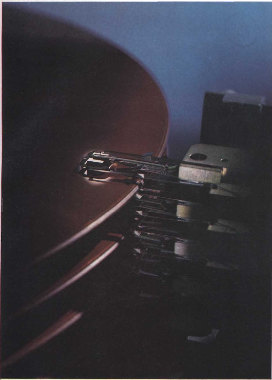
Primo piano delle testine di lettura di un winchester non ancora sigillato. La realizzazione di sistemi di questo tipo, con più dischi impilati, è estremamente complessa, a causa del perfetto allineamento che i vari dischi devono avere.
