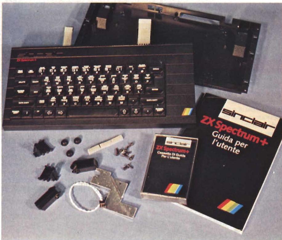
Il superkit al gran completo: dall'alto in basso, si scorgono i due semigusci, la cassetta-guida, lo user-manual e i particolari meccanici tra i quali, in basso, il nuovo dissipatore termico e il pulsante di reset.
